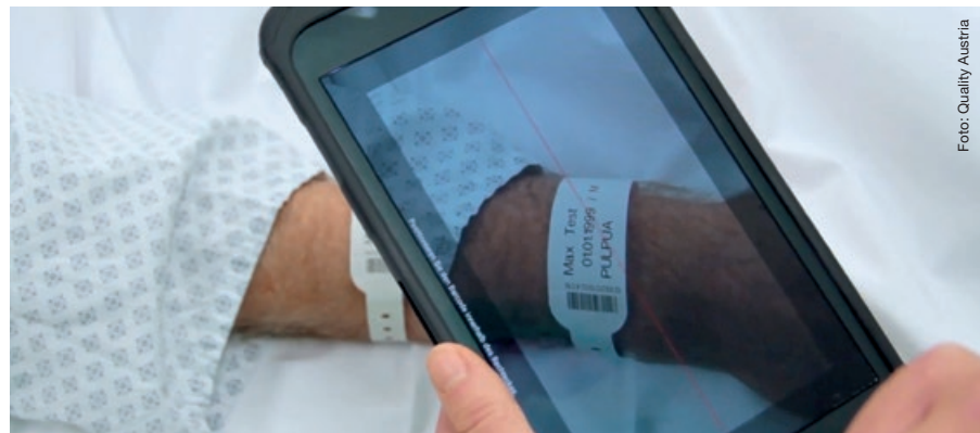
Die mobile App OPcheck erlaubt eine Identifizierung von Patienten direkt mit dem Tablet über das Patientenarmband.
